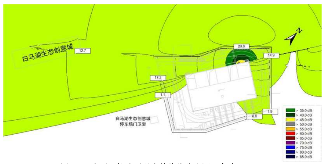
图 4-6 本项目扩建后噪声等值线分布图（离地 1.2m）
